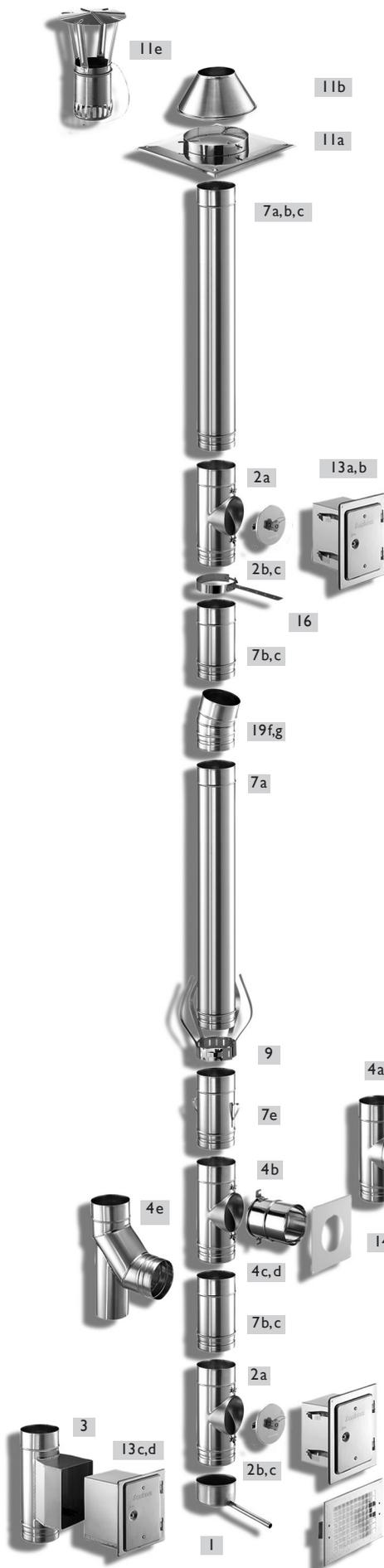
Am Ablassrohr 250 (7e) wird die Rohrsäule mit einem Seil von oben abgelassen. Die Rohrelemente (7a, 7b, 7c) mit einer Bauhöhe von 950, 450 und 200 mm werden ineinandergesteckt und mit von oben abgelassen.
